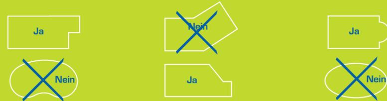
**Warnhinweis:** Damit die Abdeckung alle Sicherheitsmerkmale aufweist, darf der Abstand zwischen dem Innenrand des Beckens und der Außenkante der Abdeckung maximal 70 mm betragen. Dieses Ergebnis kann nur erzielt werden, wenn dem Hersteller ein Plan des Beckens mit an jedem Meter gemessener Länge und Breite vorliegt.
